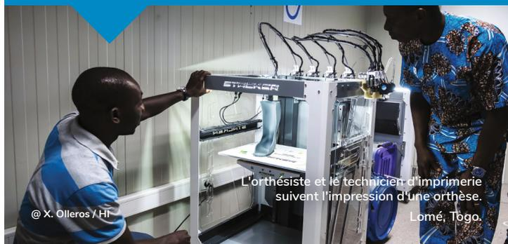
L'orthésiste et le technicien d'imprimerie suivent l'impression d'une orthèse.
